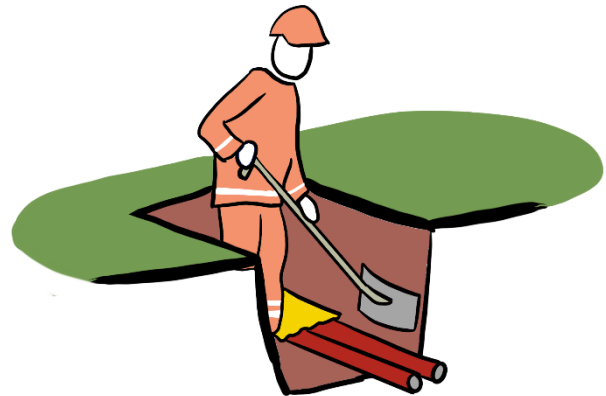
Figur 1: Grav forsigtigt ned til kablet. Håndskovl anbefales. Dækplast kan ligge meget tæt på kablet.
